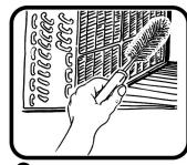
2 再以毛刷清理散熱排表面 積塵,以確保通風順暢。
