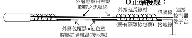
感溫棒線材外接延長線時, 務必使用有隔離線包覆的線材, 勿使用非隔離材質 (EX: 16 蕊管線), 且注意訊號線與接地線勿接反(如圖), 以確保有效隔離干擾。
