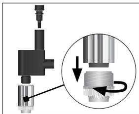
為確保打出完美的奶泡，請在使用過牛奶後每天清洗奶泡器，咖啡機不會自動提示必須拆解清洗奶泡器。
