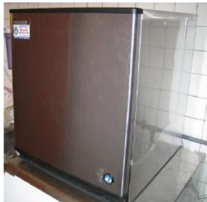
2. 拆下固定螺絲，向左方取出控制盒蓋，內有電子板
