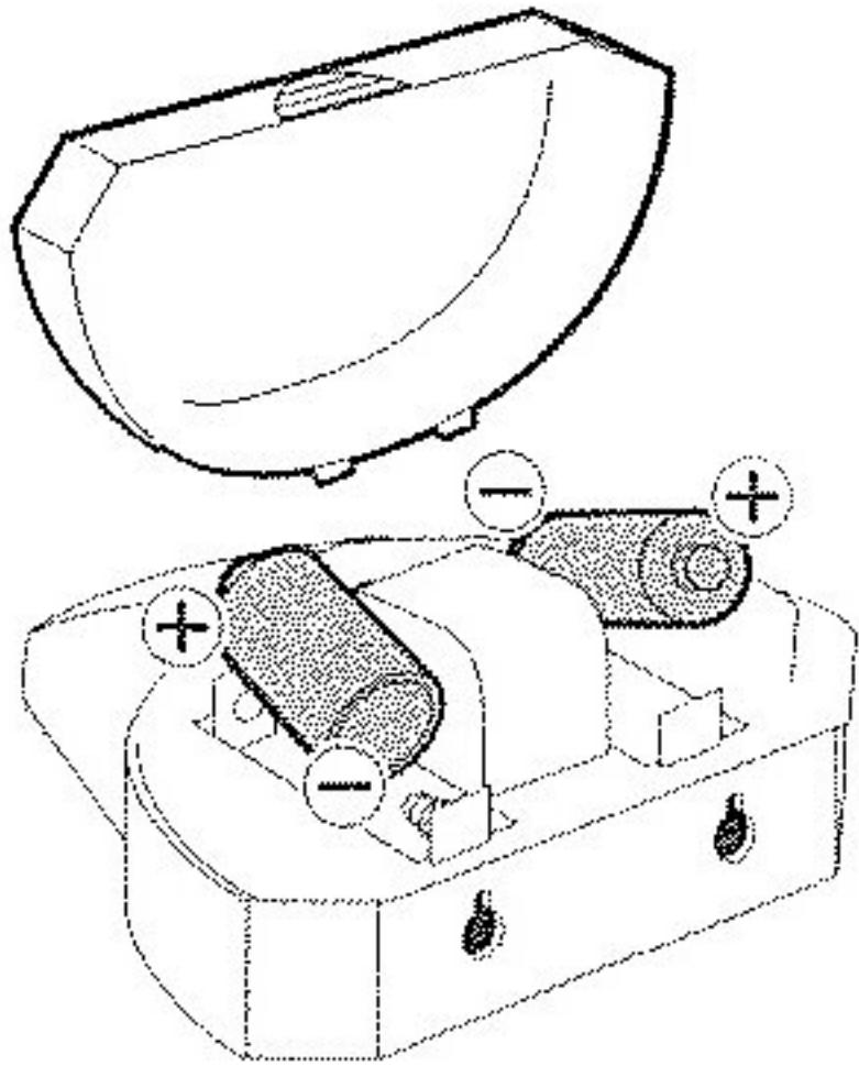
【1】確認電源開關切換至 OFF，打開電池蓋，正確安裝電池，調整旋鈕至適合的出水量後，蓋上電池蓋。
