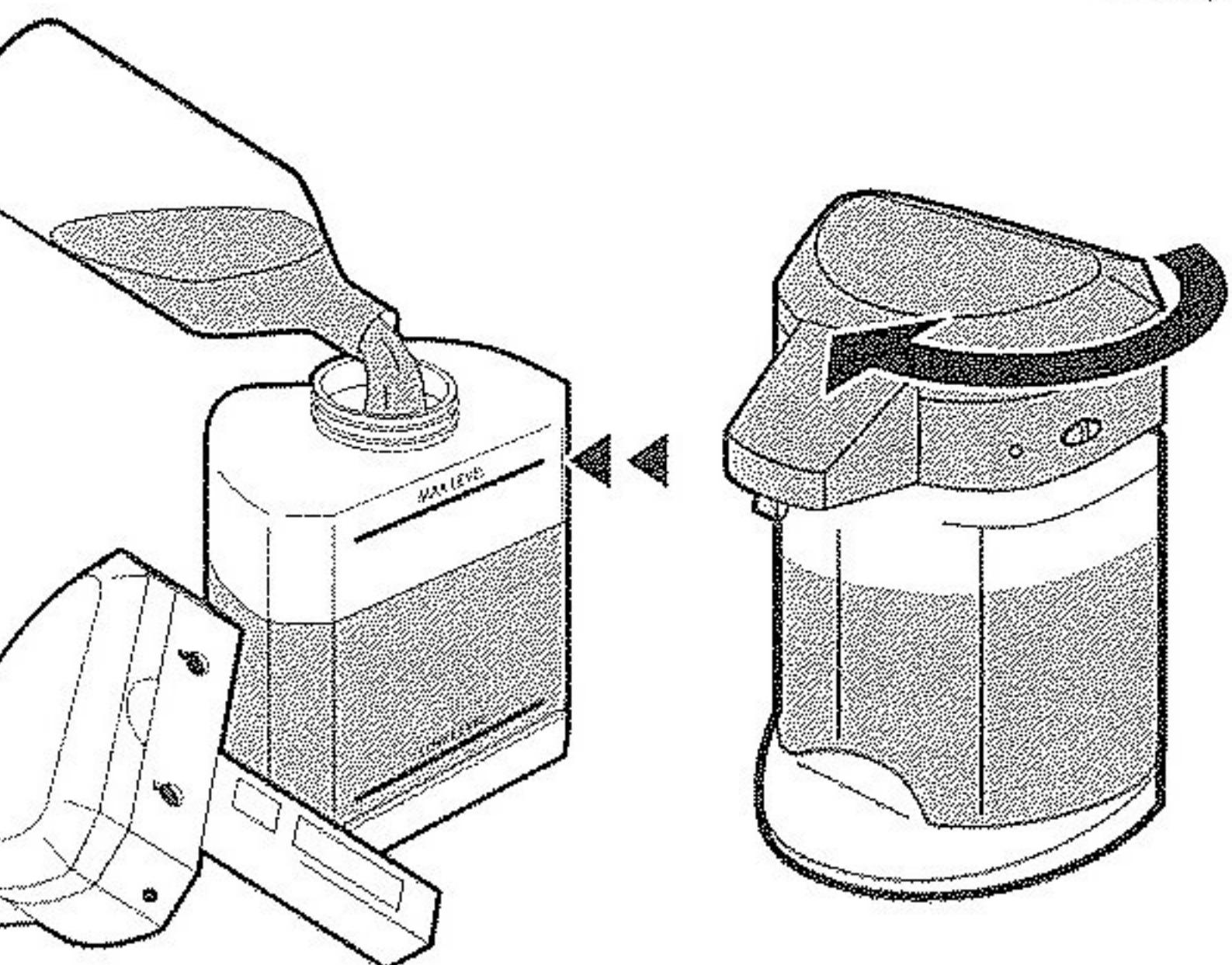
【3】向液槽瓶中加入淨手液，至液槽瓶背面上端的滿水位標記處後，旋回頂端主體即可。
