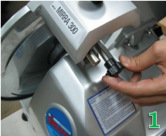
逆時鐘將後方刀盤護蓋螺絲鬆開
