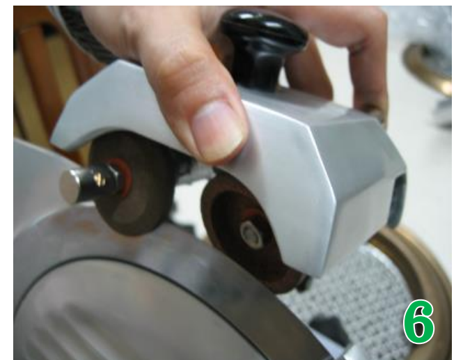
後方為粗磨刀石，按 10-15 秒放開即可 〈有火花、聲音為正常現象〉
