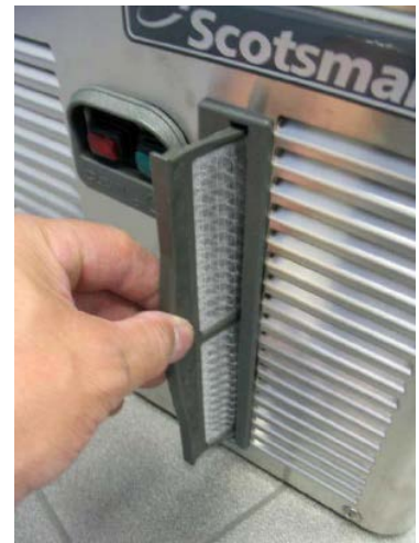
取出冷凝器濾網
